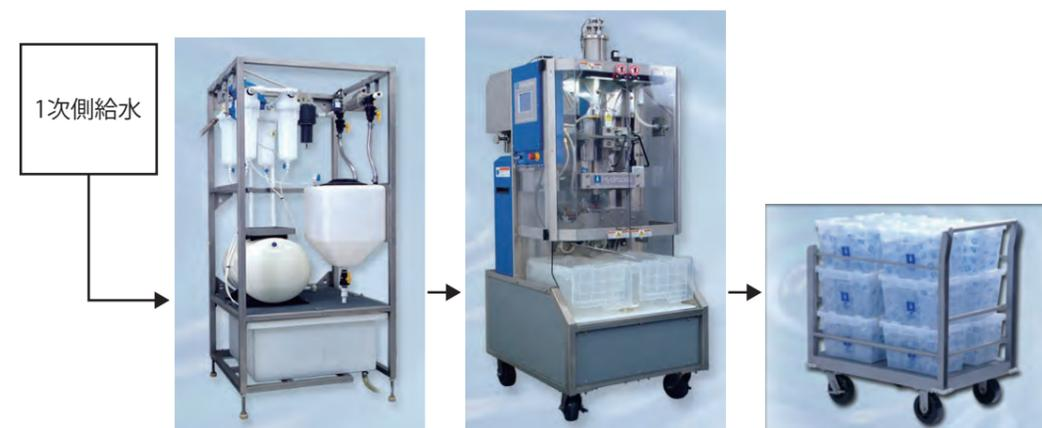
マニホールドユニット(別売)で、1次側給水を10、1.2、0.2、<sup>ミクロン</sup>0.1μmの4つのフィルターでろ過し、パウチマシンに供給します。パウチマシンは13oz(約384ml)または8oz(約236ml)のパウチを最大600個/時作成します。
