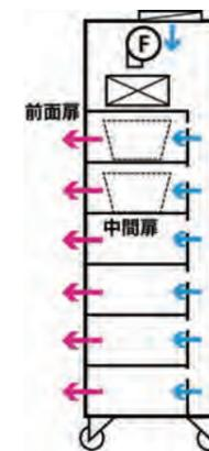
HEPAフィルターを通過した空気は飼育棚部の背面から吹き出し、前面扉の隙間より流出される。
